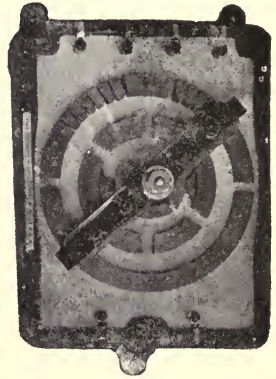
FIG. 163.—Motor Starting Switch (Vereingl. E. A. G., Vienna).
