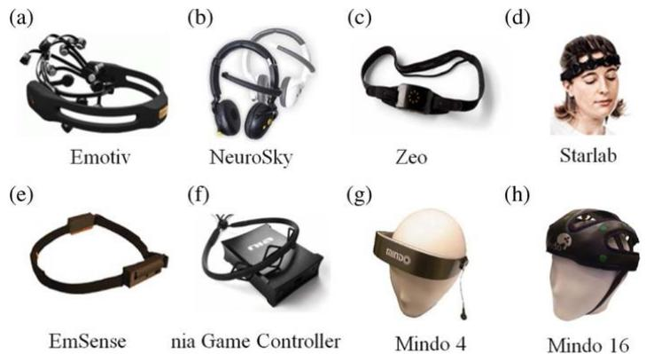
**Fig. 6.** Dispositivos de EEG Móviles disponibles en el mercado: (a) Emotiv, (b) NeuroSky, (c) Zeo, (d) Starlab, (e) EmSense, (f) Nia regulador del juego, (g) Mindo 4 con electrodos de espuma seca, y (h) Mindo 16 con sensores resistentes [20].
