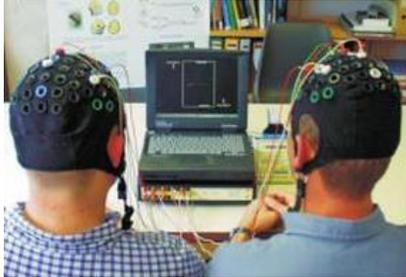
**Fig. 2.** Electroencefalograma no Invasivo para pruebas en Interfaces Cerebro Computadora [6].
