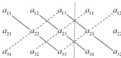
Als Merkregel für eine  $3 \times 3$ -Matrix verwendet man die *Regel von Sarrus*. Man wiederholt die erste Spalte als vierte Spalte und die zweite Spalte als fünfte Spalte. Die Produkte der durchgezogenen Diagonalen werden positiv genommen, die Produkte der gestrichelten Diagonalen negativ.
