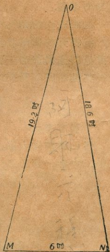
圖三十一 怎樣計算隔河的距離: 這個三角形和圖三十裏的三角形同形。從 AB 的長, 就可以計算出其餘二邊的長。
