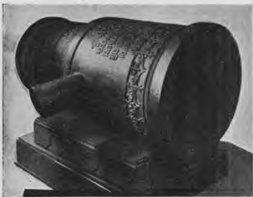
Рис. 45. Мортира Лжедимитрія, сдѣланная мастеромъ Андреемъ Чеховымъ въ 1606 г.; длина 5,6 д., калибръ 21 д., вѣсъ 116 п. 32 ф. С.П.Б. Истор. артиллерійскій музей.
