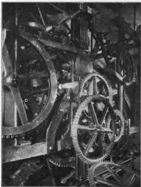
Рис. 143. Механизмъ часовъ Спасской башни.
