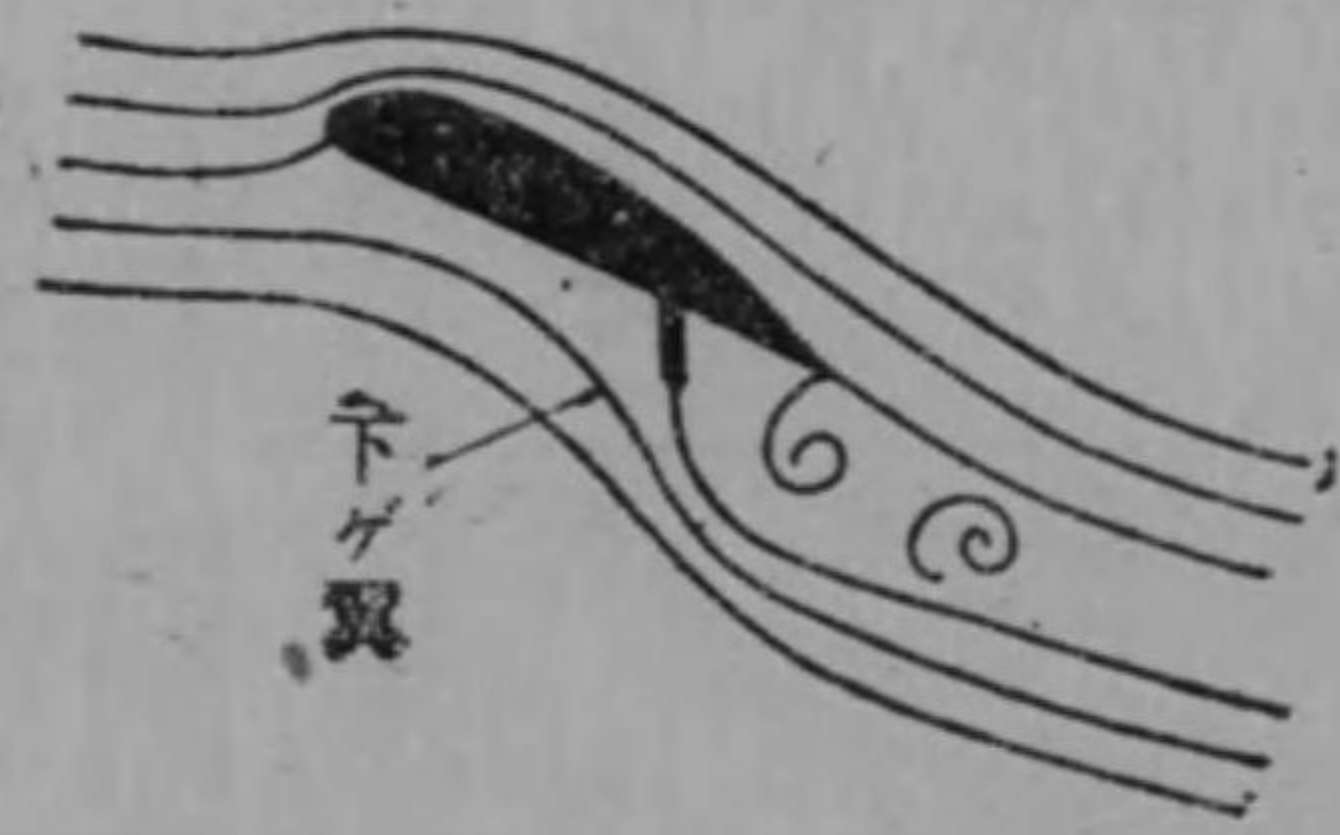
下げ翼を開いた所、下面の氣流の旋み が著しくなり揚力は極めて上昇する。
