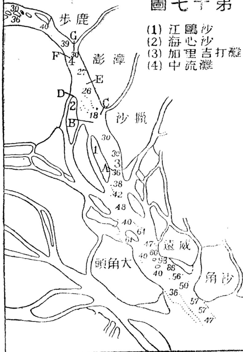
邊；二、於此河右岸，由海心沙之B點起，另築至第二門洲下端。三、於此河左岸，自漳澎尾沙下頭C點，築至第二門洲下端。四、築在此河右岸與海心沙中間，（第七圖之D點），五、在漳澎（在英文原本，只有漳澎島而未有言及常安圍，此圍諺是漳澎島上之小地名，翻譯時，因欲詳細而添上者。註）常安圍上游E點起築至第二門洲壩之上端。六、在右岸長洲島與第二門洲之間適中之處F點起，築至中流灘之頂上。七、於鹿步墟島下端G點起築至中流。以此七壩，自黃浦迄於虎門之水可得有條理，而冲刷河底可致四十英尺以上之深，使航洋巨舶自公海直通廣州。
