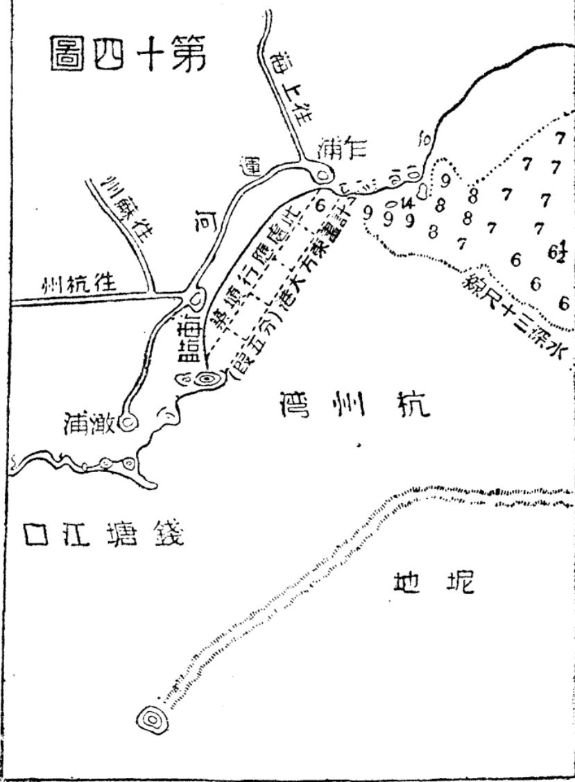
一端離山數百尺之處，開一缺口，以爲港之正門。此種海堤可分爲五段，每段各長三英里。現在先築一段，長三英里，闊一英里半，得三四方英里之港面，已足供用。至於商務長進，則可以逐段加築。前面海堤，應以石塊或土敏士堅結築之，橫於海堤與陸地間之堤，則可用砂及柴蓆疊成，作爲暫時建造，以備擴張港面時之移動。
