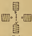
Magnetisches Feld des Wechselstrommotors von Tesla.
