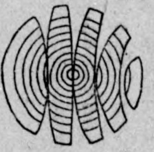
③ 板類は凡て木表に向つて反り返るものにして年輪の方向に収縮する状態を示す
