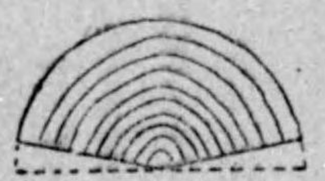
① 丸太の半分が半徑の方向に収縮する状態を示す
