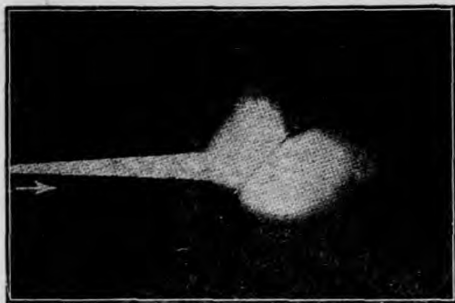
圖5.13 蒙砂玻璃的反射和透射
