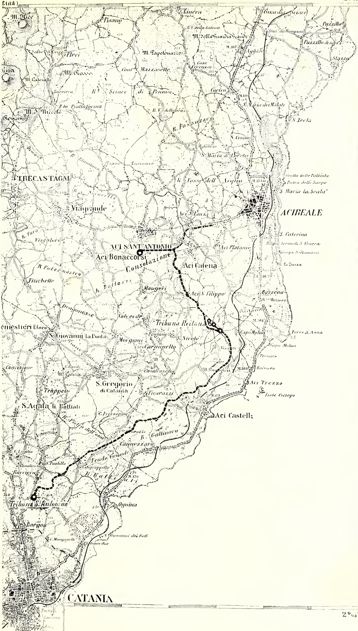
Condotta delle acque Consolazione e Reitana dalle sorgenti alla tribuna S. Antonino.
