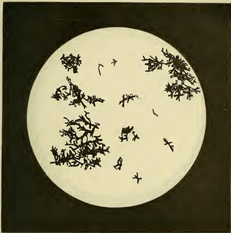
Calomel, durch Schwefligsäureanhydrid aus verdünnter Quecksilberchloridlösung bei 70<sup>0</sup> bis 80<sup>0</sup> C. abgeschieden.
