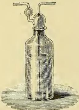
Soll der Chlorentwickelungsapparat ausser Thätigkeit gesetzt werden, so ist um ein Zurücksteigen der Flüssigkeit zu verhindern, vor der Entfernung des Feuers unter dem Entwicklungskolben, die zwischen diesem und der Waschflasche befindliche Kautschukverbindung zu öffnen.
