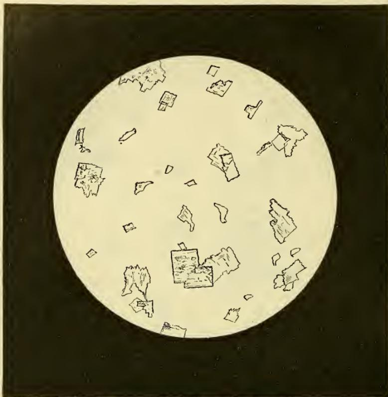
Calomel, durch Schwefligsäureanhydrid aus concentrirter Quecksilberchloridlösung bei 30° bis 35° abgeschieden.
