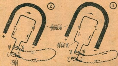
交流發電機發電原理
