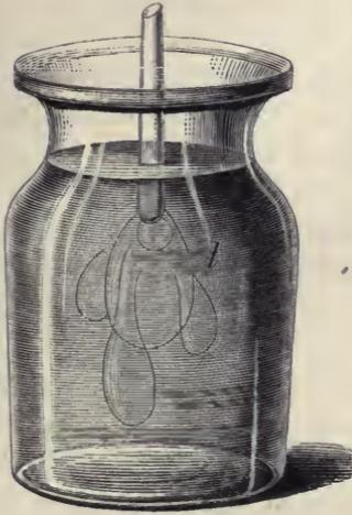
FIG. 3. Apparat zur Herstellung der TRAUBE'schen Zelle.
