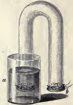
FIG. 398. Vorrichtung für osmotische Versuche. Die Mündung des U-Rohres in *a* in Wasser und die Mündung in *b* mit Blase oder Pergamentpapier verbunden, nachdem das Rohr mit Zucker- oder Gummilösung gefüllt ist.
