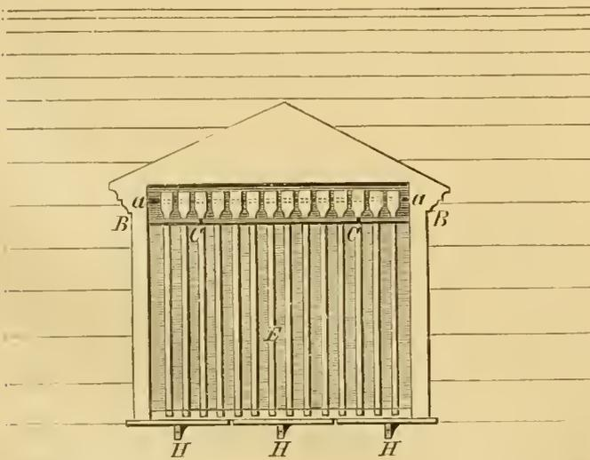
Der Draht läuft nach Innen zu über eine Rolle D. Mit einem mässigen Zuge lassen sich sämmtliche an der Welle A. senkrecht hängenden Holzstäbchen E. an die innere Decke des
