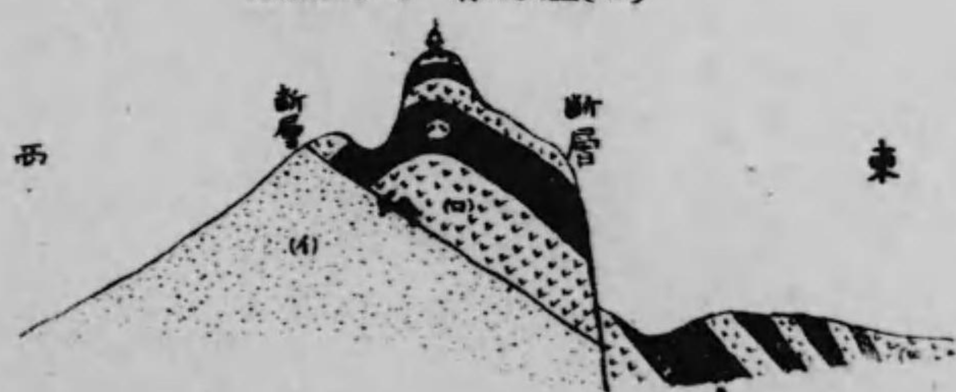
第 十六 圖 ヲグリアー、トーダ鐵床断面圖 (イ) 綠麻石柘榴岩(接磁礦物帶) (ハ) 磁鐵礦 正長岩
