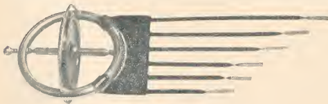
Fig. 1. Resonanzkreisel. Natürl. Größe 19 cm.
