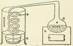
FIGURE 46 .- Distilling Apparatus.
