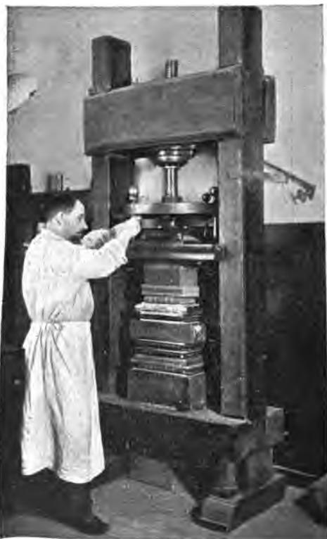
**Fig. 56. — LA PRESSE A PERCUSSION ;** Placement des volumes en presse après l'achèvement ou pour le polissage des plats au moyen de plaques.
