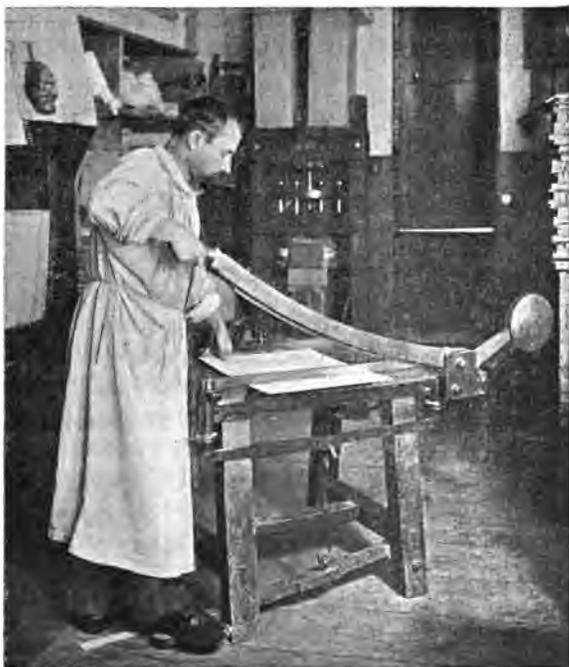
Fig. 23. — Coupe du carton, au moyen de la cisaille.
