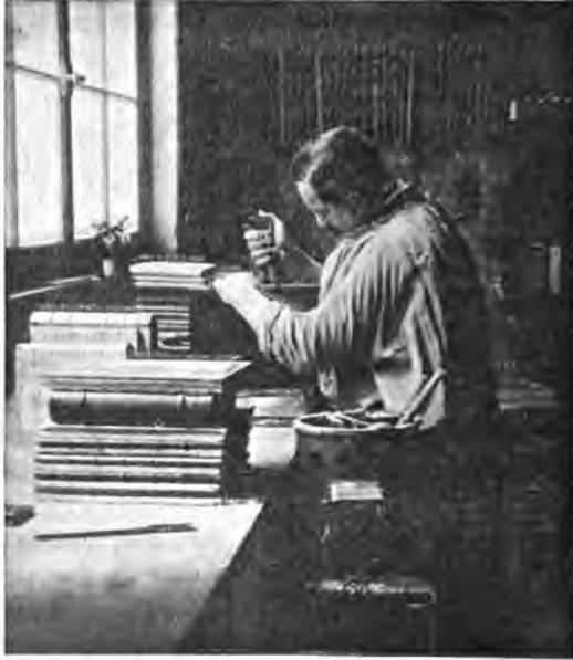
Fig. 48. — COUVREUR ; Formation des nervures au moyen de la pince.
