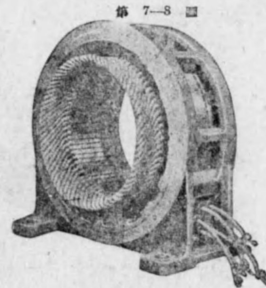
誘導電動機の固定子
