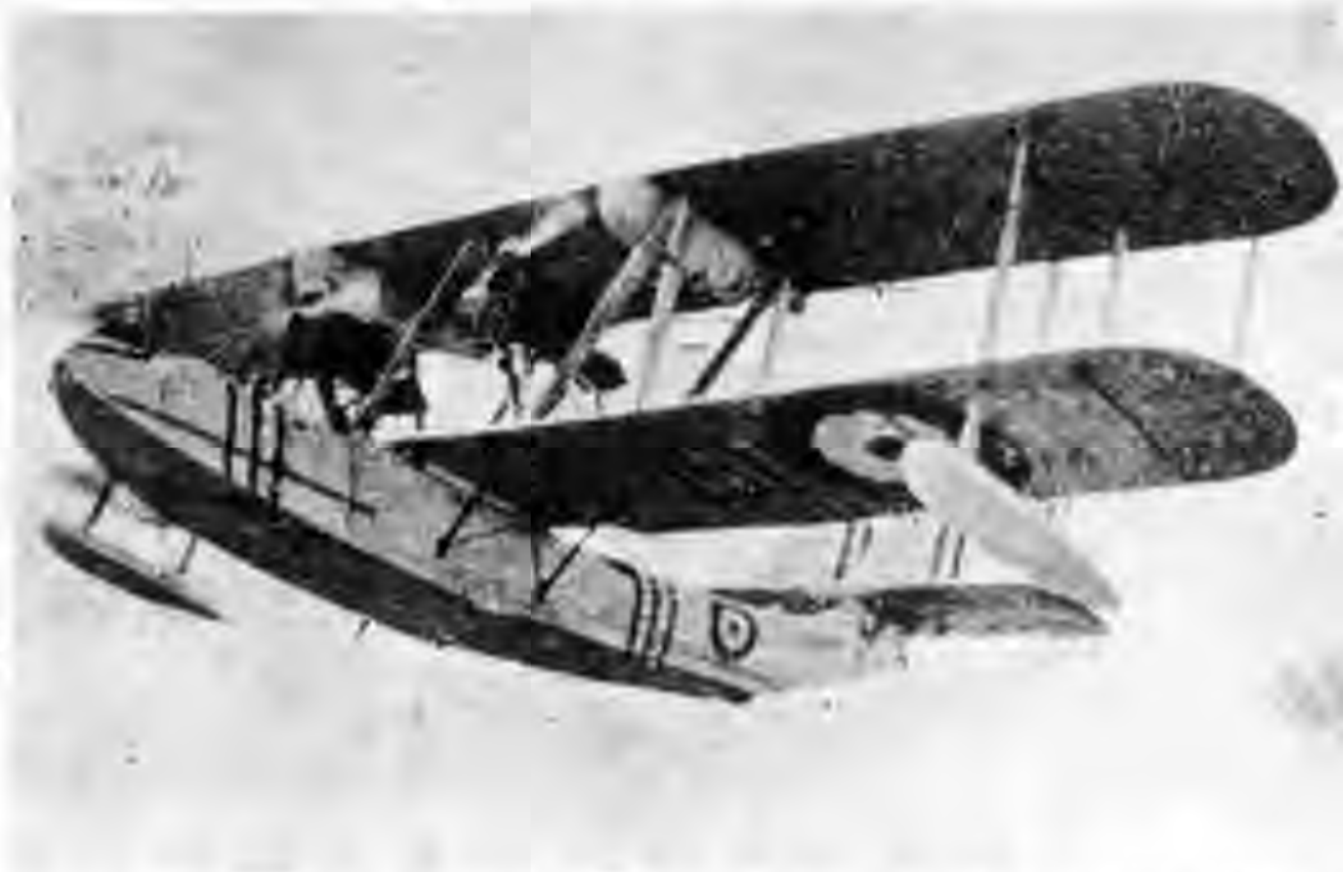
上圖爲納伯爾式五金質皮殼之飛行艇爲遠東飛行之艇
