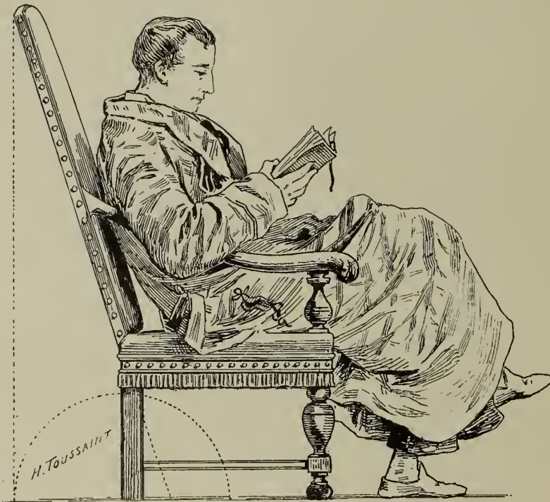
Fig. 45. La perpendiculaire abaissée du sommet du dossier ne doit jamais tomber à une distance du pied de derrière, supérieure à la moitié de l'écartement du piètement .
