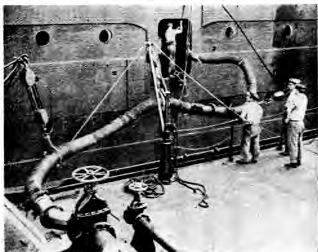
第十圖 裝儲燃料油(注意船旁的輸油管)
