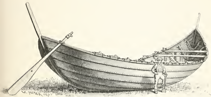
94. Fartyg af ek för fjorton par åror, från det 4:e århundradet efter Kr. föd. Slesvig.
