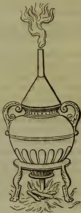
Figure d'un pot et entonnoir, pour receuoir la vapeur et fumee.
