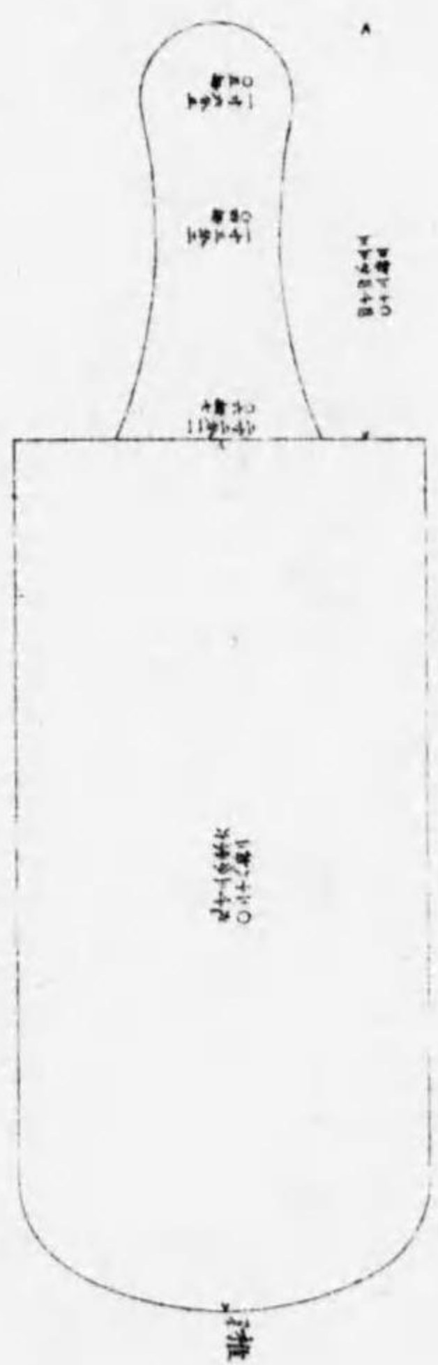
二十斤湯龍環藥量樽 徑四寸四分 重八斤七分六厘 ○五斤五分 ○五斤七分六厘
