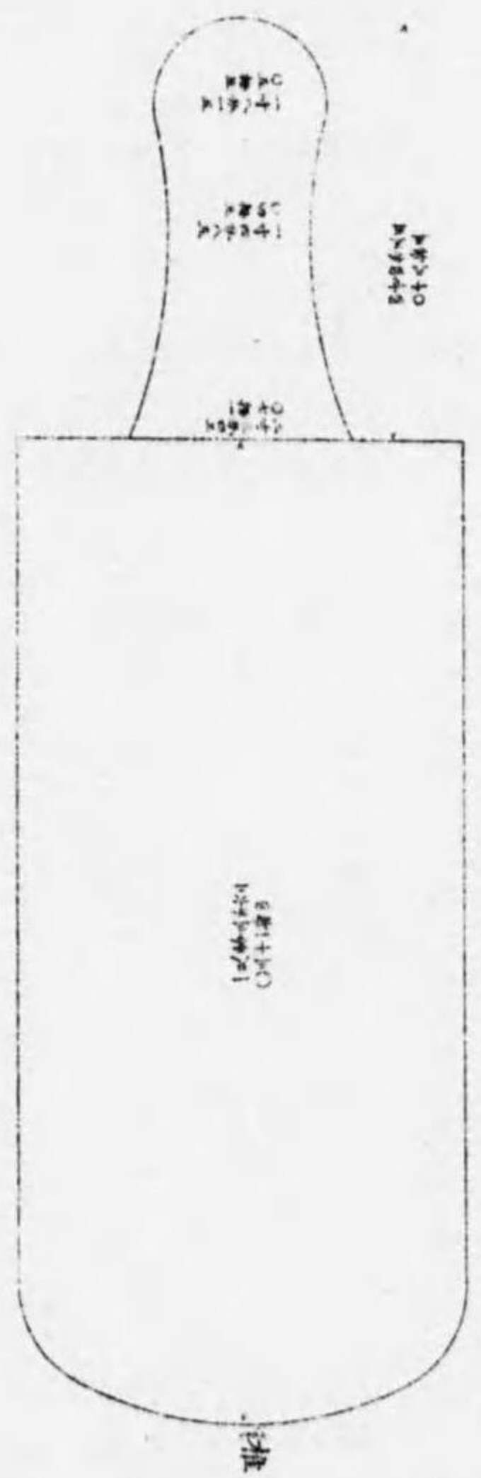
二十四斤地盤藥液樽 徑四寸五分 重四斤五分 高九寸五分
