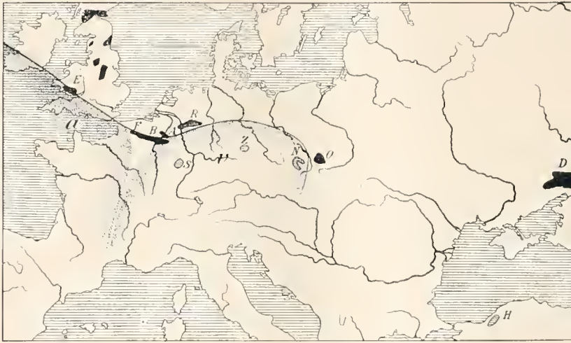
Fig. 1. Übersicht über die in Betracht gezogenen Steinkohlenvorkommen. Die schwarz ausgefüllten Felder sind paralische Reviere, die schraffierten Binnenreviere. D = Donetz Revier (Rußland); O = Oberschles. Revier; R = Ruhrrevier; A = Aachener, B = Belgisches, F = Nordfranzösisches (Valenciennes) Revier; E = Englische Reviere; S = Saarrevier; Z = Zwickauer, N = Niederschl. böhm. Revier; H = Revier von Heraclee (Eregli) in Kleinasien.
