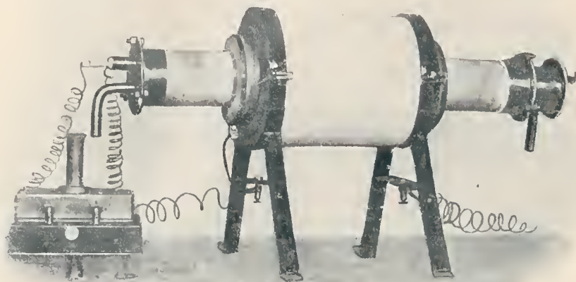
Fig. 4. Elektrisch geheizter Horizontalofen mit Flanschen, Rohrstopfen und Pyrometer, daneben Millivoltmeter zum Ablesen der Temperatur.
