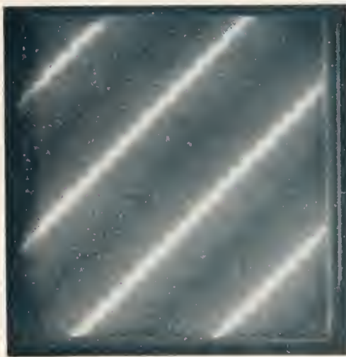
Fig. 9. Moiré-Streifung, durch Rasterplatten erzeugt.
