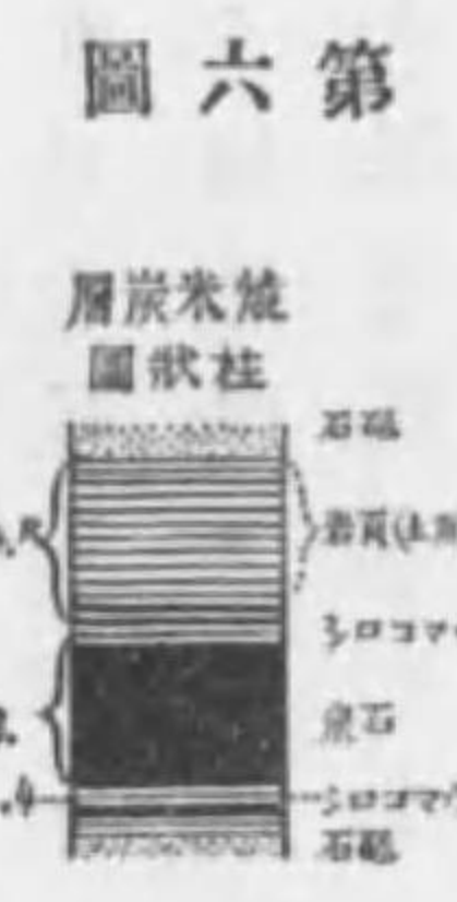
第六圖 採炭シ得ヘキハ厚サ三尺ニシテ其上下磐ニ「ウマコ ロシ」ヲ介在シ下磐ニ炭ノ薄條ヲ夾入ス 左ニ塊炭分析ヲ示ス(分析課)百分中
