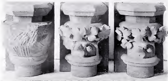
Abbildung 16. Werdegang eines Sandsteinkapitälts. Die Abbildung erklärt sich wohl von selbst; sie zeigt dem kunstgewerblichen Anfänger und dem Laien, wie der Steinbildhauer allmählich aus den großen Massen die Details herausarbeitet.
