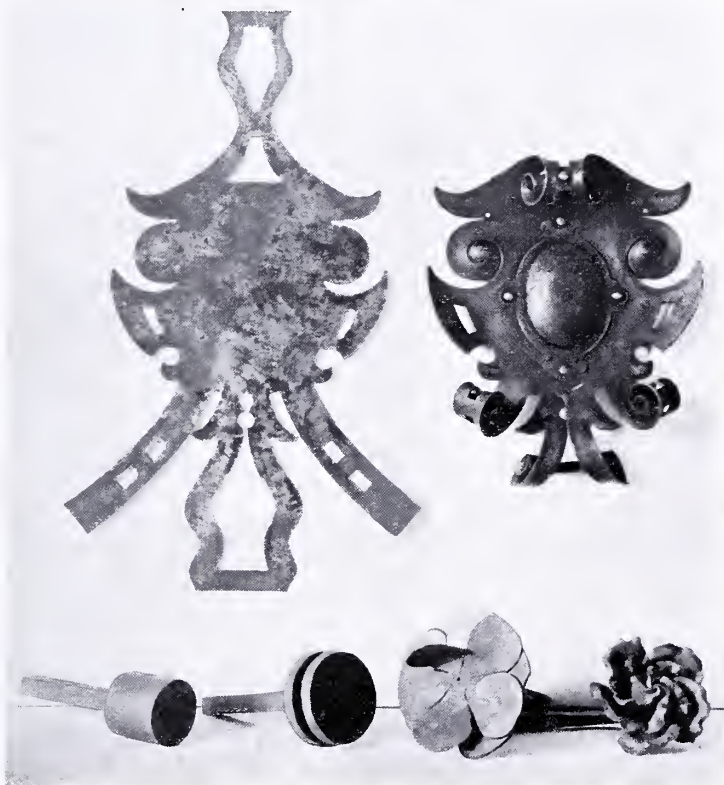
Abbildung 7. Entstehung einer aus dem Vollen geschmiedeten Rose und einer Kartusche aus Eisenblech. Bei dem ersteren »Werdegang« ist gezeigt, wie der Kunstschlosser aus einem zylindrischen Stück Eisen allmählich die einzelnen Blumenkronenblätter abspalten muß, um diese dann in rotwarmem Zustand mit Zange und Hammer in die gewünschte Form zu bringen.
