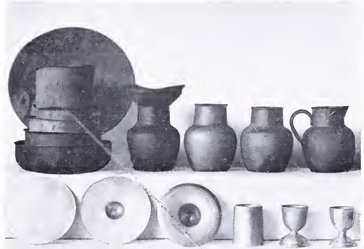
Abbildung 9. Werdegang eines Kännchens aus Eisenblech und eines Eierbeckers aus Aluminiumblech. Es wird an dieser Entwicklungsreihe gezeigt, wie der Metalldrücker aus einem kreisrunden Stück Blech allmählich ein Gefäß von jeder Form entstehen lassen kann. In der Sammlung sind auch noch die Stadien der Emaillierung des Kännchens zu sehen.
