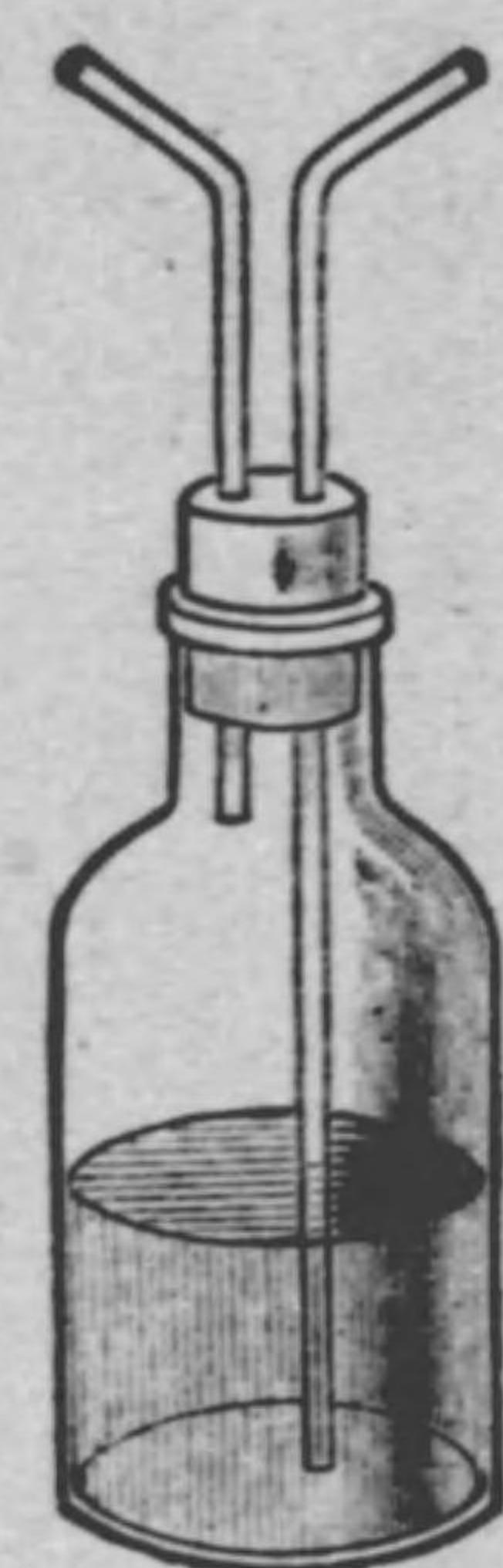
長短二本の曲れるガラス管を通したるコルク栓をその口に嵌む。今短き管より瓶内の空氣を吸へば、外の空氣は長き管より入りて石灰水中を通る。かくするも石灰水は僅に濁るのみ。次に長き管より息を石灰水中に吹入るゝに、石灰水は忽ち白く濁りて乳の如くになる。
