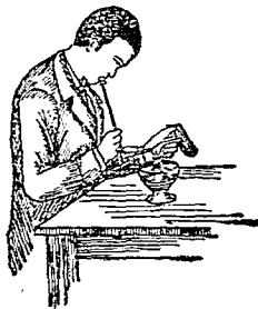
吹管分析之形狀 （圖之孔小上炭木於焰火吹管吹以）
