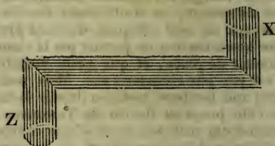
» On peut faire des tuyaux de différente longueur, qui se joindront l'un à l'autre, et qui serviront aux fenêtres plus élevées. Comme ces tuyaux doivent être de planches de sapin fort minces, d'environ cinq pouces de large, il n'est pas nécessaire de les clouer ensemble dans la forme d'un tuyau, jusqu'à ce qu'on en ait besoin; elles peuvent, par cette raison, occuper moins de place.
