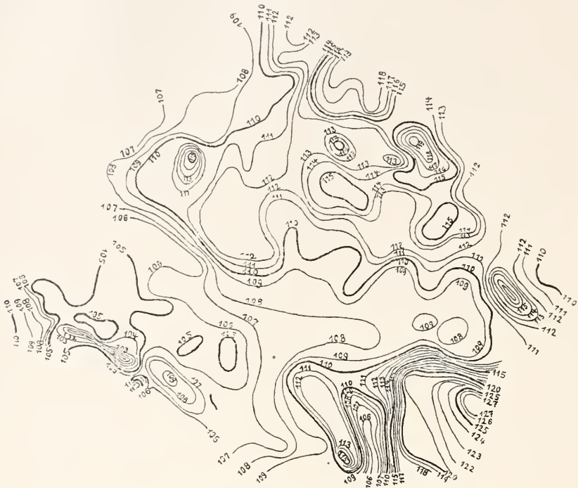
Fig. 4. Drucklinien des artesischen Wassers von Kl. Leipisch. Maßstab 1:50 000. Nach Keilhack.
