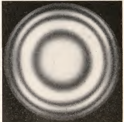
Fig. 7. Interferenzbild einer zirkularpolarisierenden kristallinen Flüssigkeit, Optisch aktiver Amylester der Anisalaminozimtsäure. Nach Vorländer.
