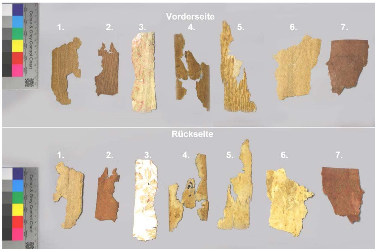
**Abb. 38**<sup>314</sup> Vorder- und Rückseite der Reparaturschichten (Reihenfolge von der Ältesten zur Jüngsten).
