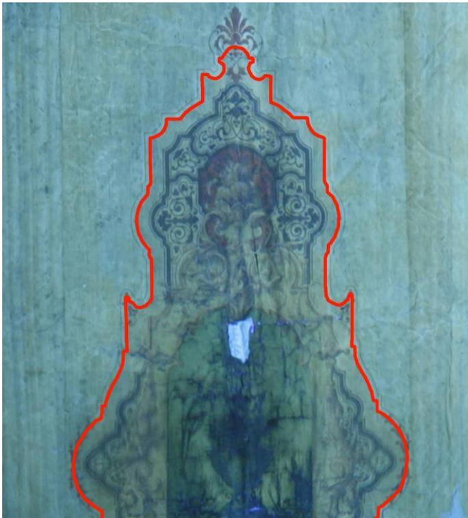
**Abb. 12**<sup>106</sup> Detail der Bildkartusche des Elements TAP 14A im UV-Licht, innerhalb der roten Markierung ohne bläuliche Fluoreszenz und somit ohne Überzug.
