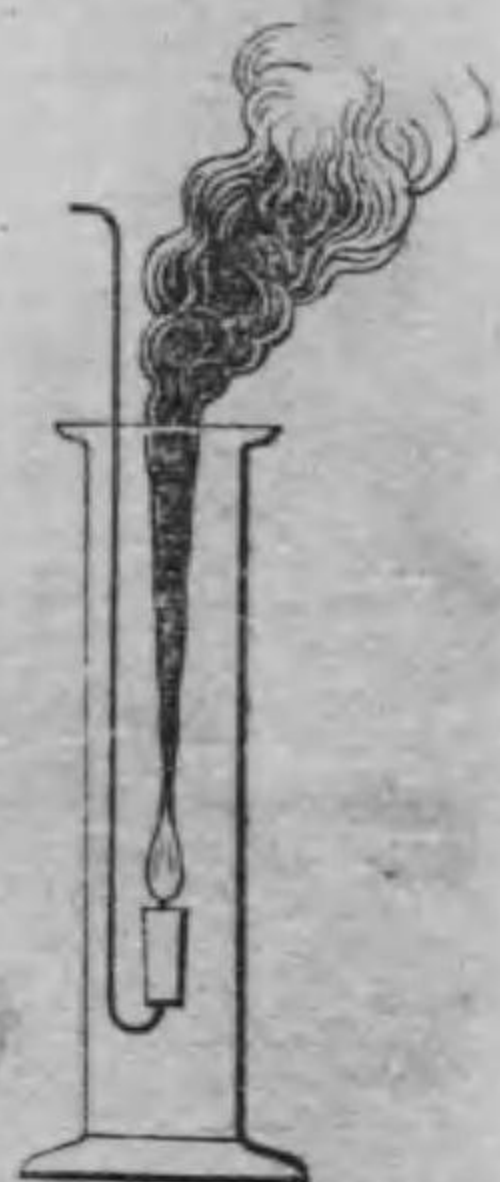
第37圖—蠟燭が鹽素中に煤煙を揚げて燃焼す。
