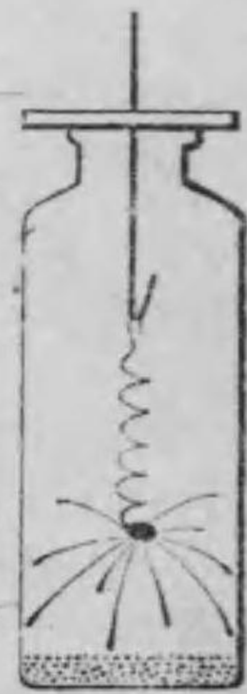
第6圖—酸素中にて鐵線を燃焼す。
