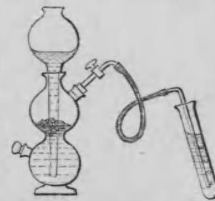
第64圖—鹽類溶液に硫化水素を通じて硫化金屬を沈澱せしむ。
