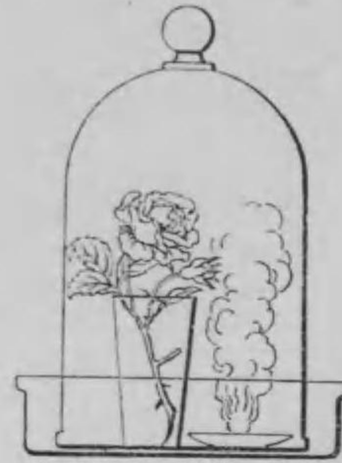
第65圖—硫黄の燃焼により生ずる無水亞硫酸にて草花を褪色せしむ。
