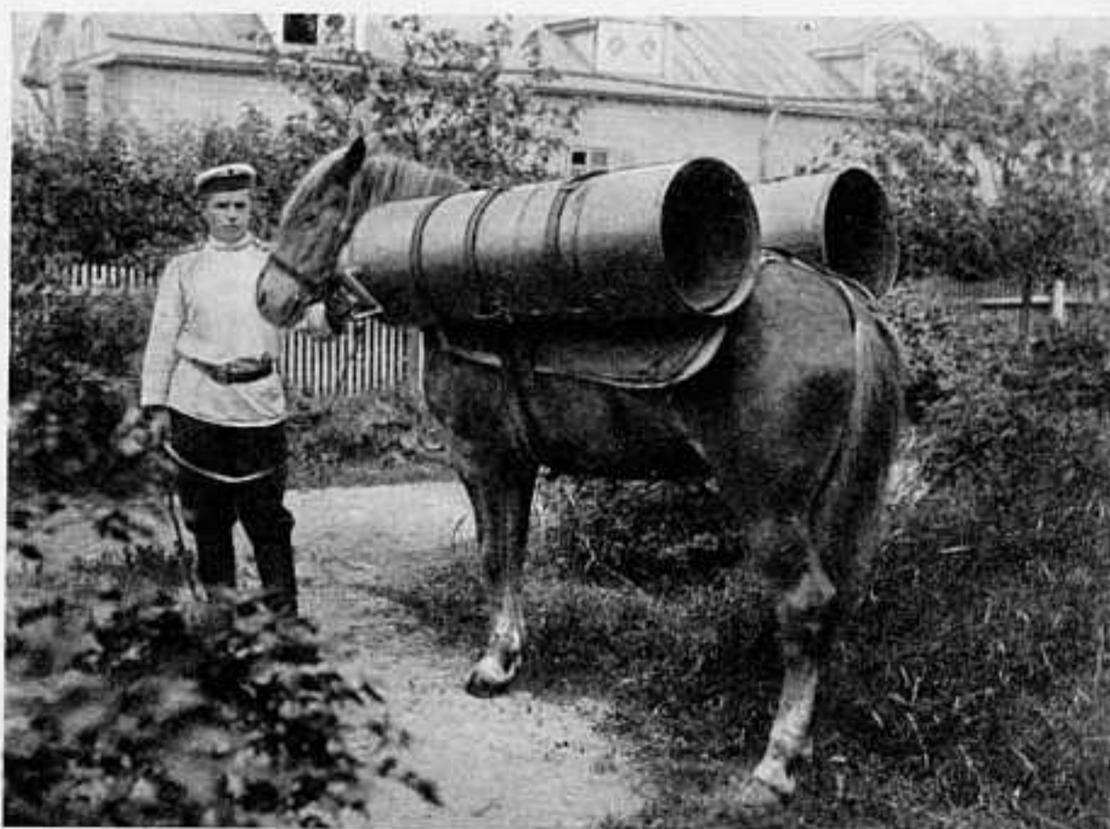
ЧАСТЬ ВЬЮЧНАГО ГАЗОДОБЫВАТЕЛЬНАГО АППАРАТА.
