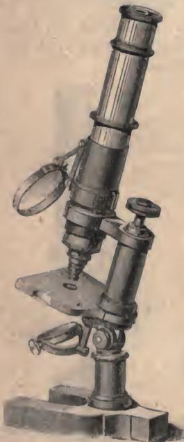
Fig. 32. Kleineres Instrument v. Hartnack, zum Umlegen eingerichtet.
