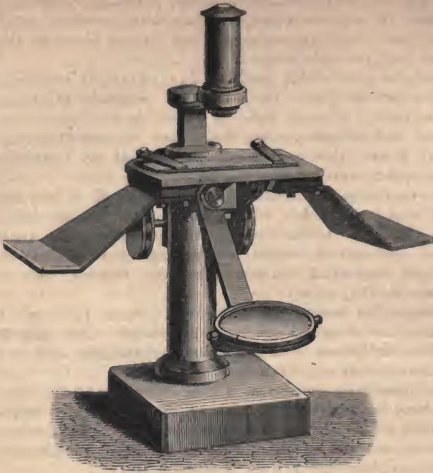
Fig. 74. Neues Präparirmikroskop von Zeiss.
