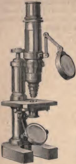
Fig. 35. Kleines Hufeisen-Mikroskop von Hartnack mit eingezogenem Rohr.
