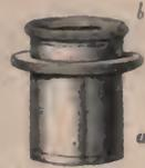
Fig. 50. Polarisator. Die Röhre *a* in den Tisch eingepasst; *b* Sammellinse aus Flintglas.
