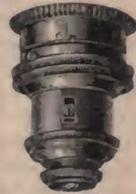
Fig. 64. Immersionssystem No. 9 von Hartnack.
