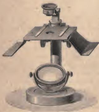
Fig. 7. Einfaches Mikroskop von Nachet.
