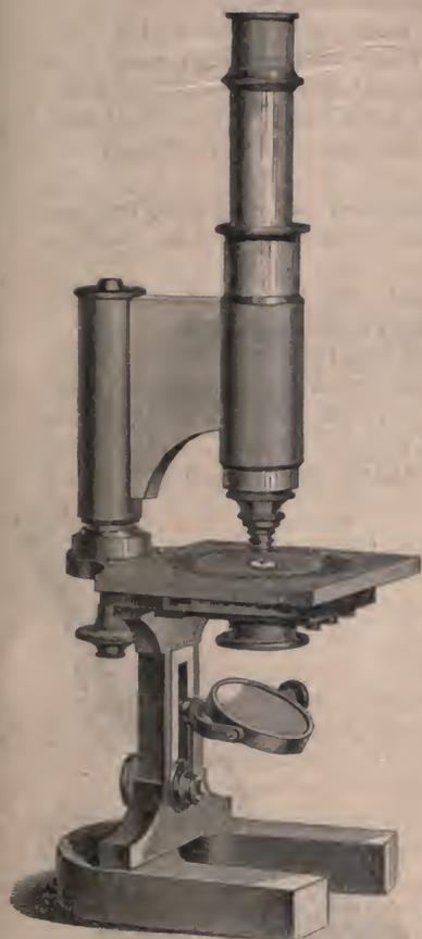
Fig. 33. Grosses älteres Hufeisen-Mikroskop von Oberhäuser und Hartnack.
