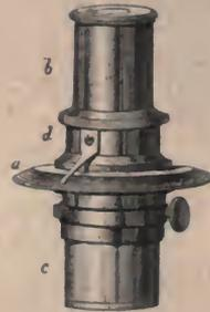
Fig. 51. Hartnack's Analysator neuer Konstruktion. Das Okular *b c* dreht sich in einer Hülse, welche durch die Schraube rechts an dem Mikroskop fixirt wird und einen graduirten Kreisbogen bei *a* führt; *d* Nonius.
