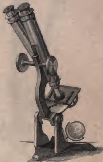
Fig. 17. Stereoskopisches Mikroskop von Crouch.
