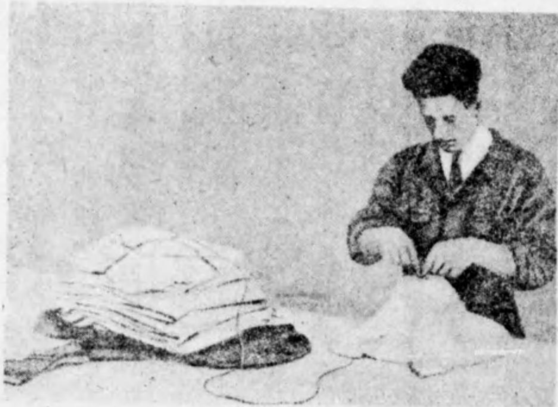
第二十圖 (左) アエロズール落下傘の疊まれたまままだ包装されない前の全圖 (右) 補助傘の修繕
