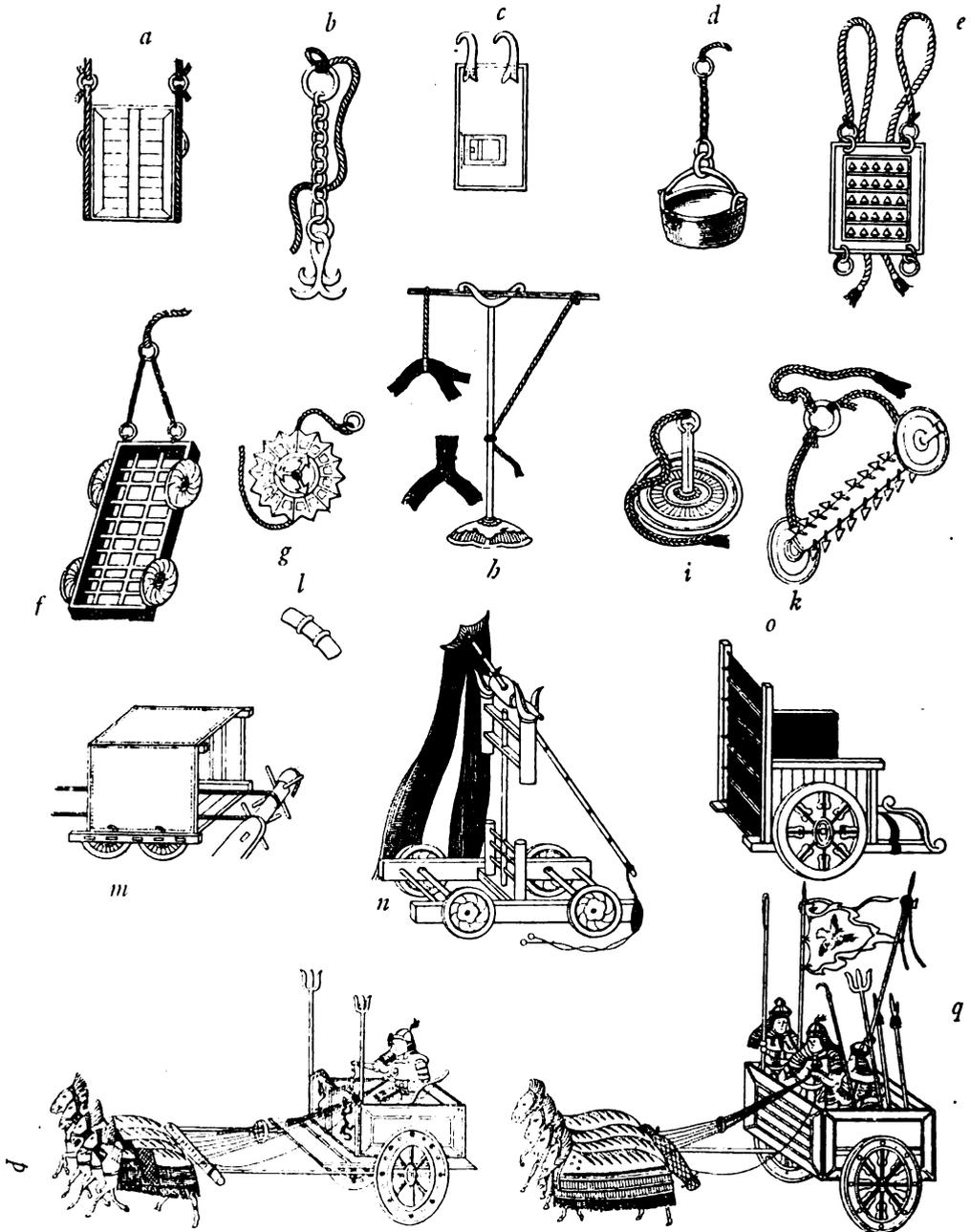
Fig. 47. Streitwagen und Belagerungsmaschinen.
