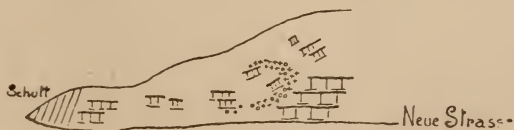
Fig. 6. Aufschluß an der neuen Straße am Westende des Mayr-Bruches. Einzelne Bänke der Brekzie ragen in ungestörter horizontaler Lagerung aus dem Hang heraus; einige große Blöcke sind aus ihrer Lage gebracht, Moränenmaterial mit über faustgroßen Geschieben füllt die Lücken zwischen gestörten und ungestörten Brekzienblöcken aus.
