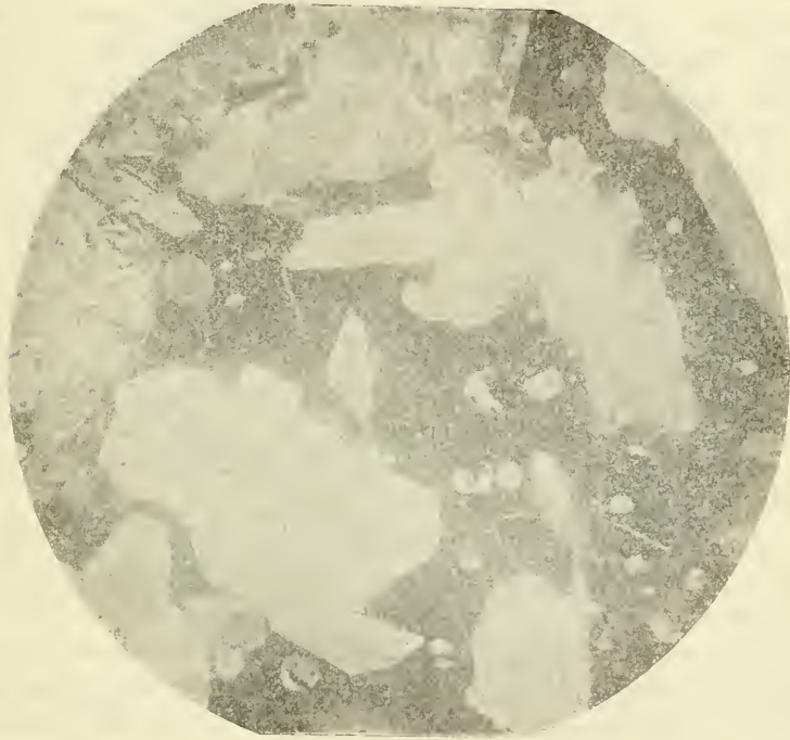
Fig. 5. Gediegen Kupfer in den rundlichen Mandelräumen und in der Grundmasse des Diabasporphyrts der Mina Mercedes bei Algodones.
