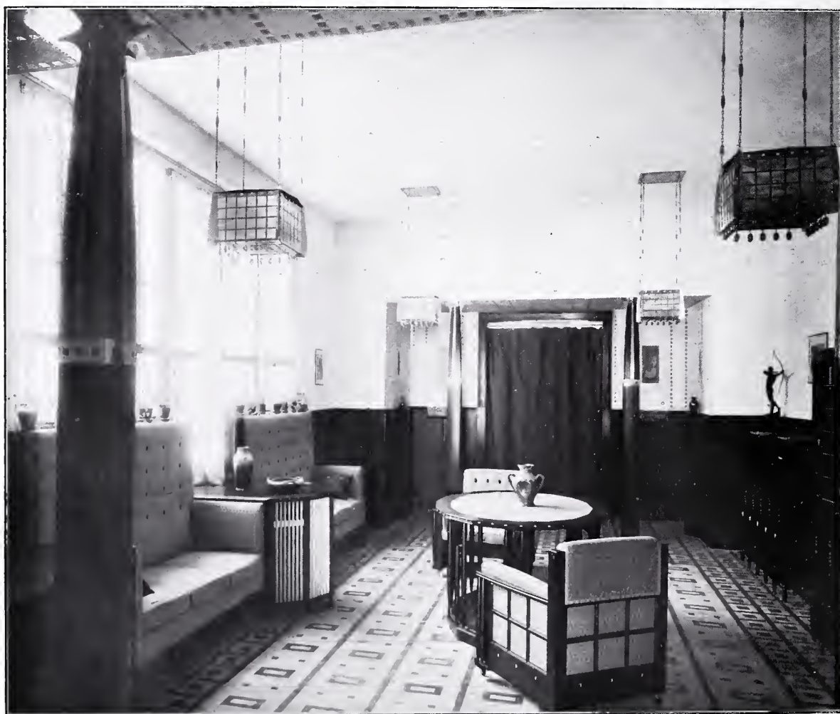
Vorzimmer von Albert Geßner-Berlin — Fußboden in Hirnholzparkett (Nußbaum und Ahorn) von Adolf Burkle-Bruchsal i. B. — Tragpfeiler in Holz mit Messingbeschlägen — Wände mit Verzierungen in Glasmosaik — Möbel, Wandpanel und Heizverkleidung in Wassereiche mit Holzintarsien und Elfenbeineinlage — Bogenschütze in Bronze von E. M. Geyger
