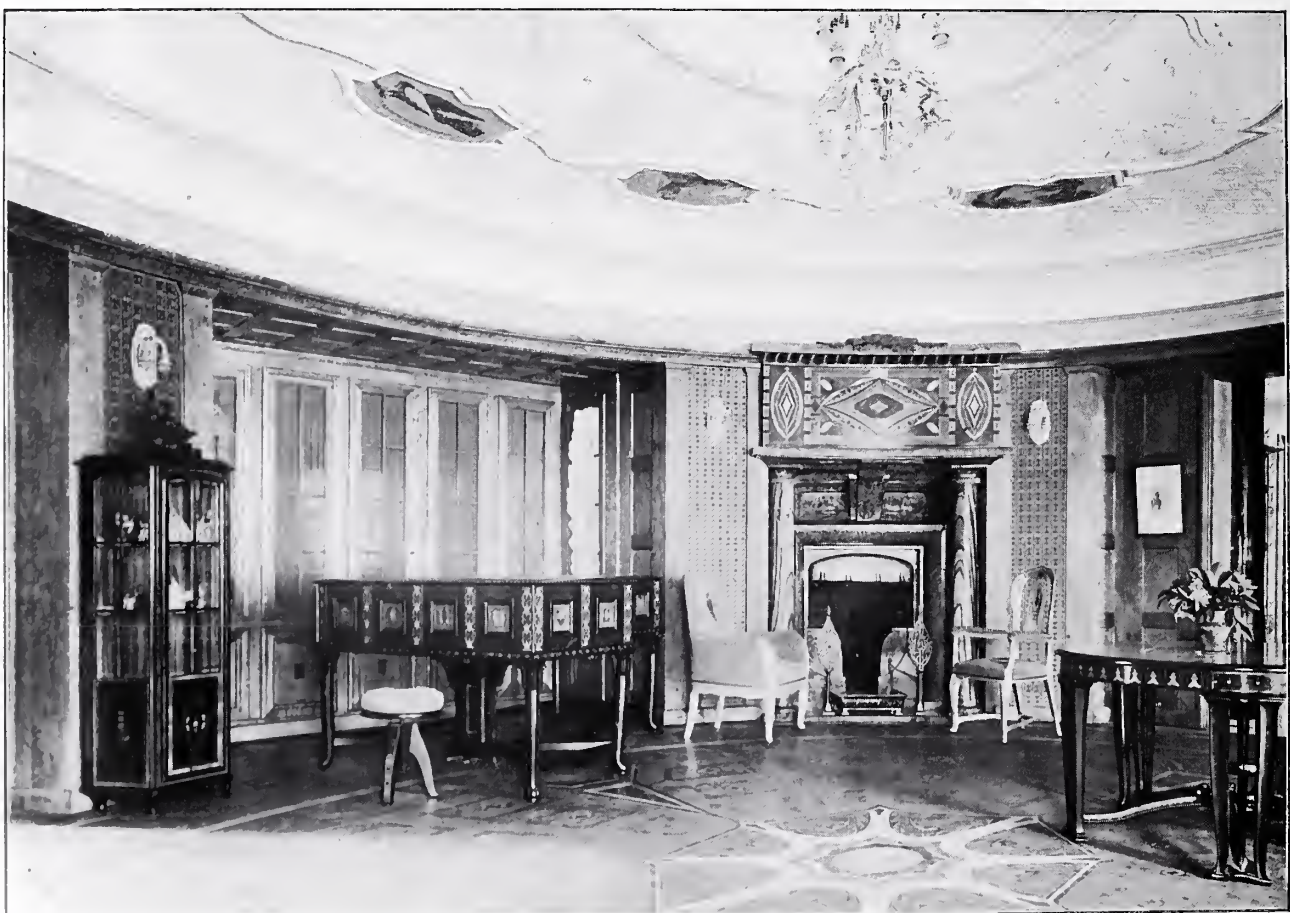
Salon von Wilhelm Kreis-Dresden, ausgeführt von den Dresdener Werkstätten für Handwerkskunst — Wandbekleidung in Björkholz — Parkettfußboden aus Esche, Nußbaum und Polisaner (Vereinsparkettfabrik A.-G. Dresden) — Flügel in Polisaner mit Intarsien (Ibach-Barmen) — Marmorkamin (Saalburger Marmorwerke) — Deckenbeleuchtung: Porzellankrone für elektrisches Licht (Meißener Manufaktur) — Stuckdecke, angetragene Arbeit von Peter Henseler-Dresden — Kamineinsatz und Haube: Juwelier Ehrenlechner-Dresden
