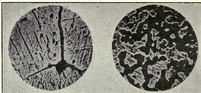
A. FIG. 52. B. A. Alloy, copper 23 per cent., zinc 77 per cent. B. Alloy, copper 20·5 per cent., zinc 79·5 per cent. V, 100 ×.
