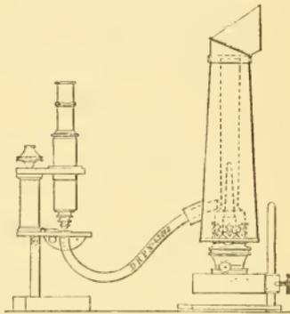
Durch Umdrehen des Stabes um seine Achse und entsprechende Höherstellung der Lampe kann man auch undurchsichtige Gegenstände sehr gut von oben beleuchten.
