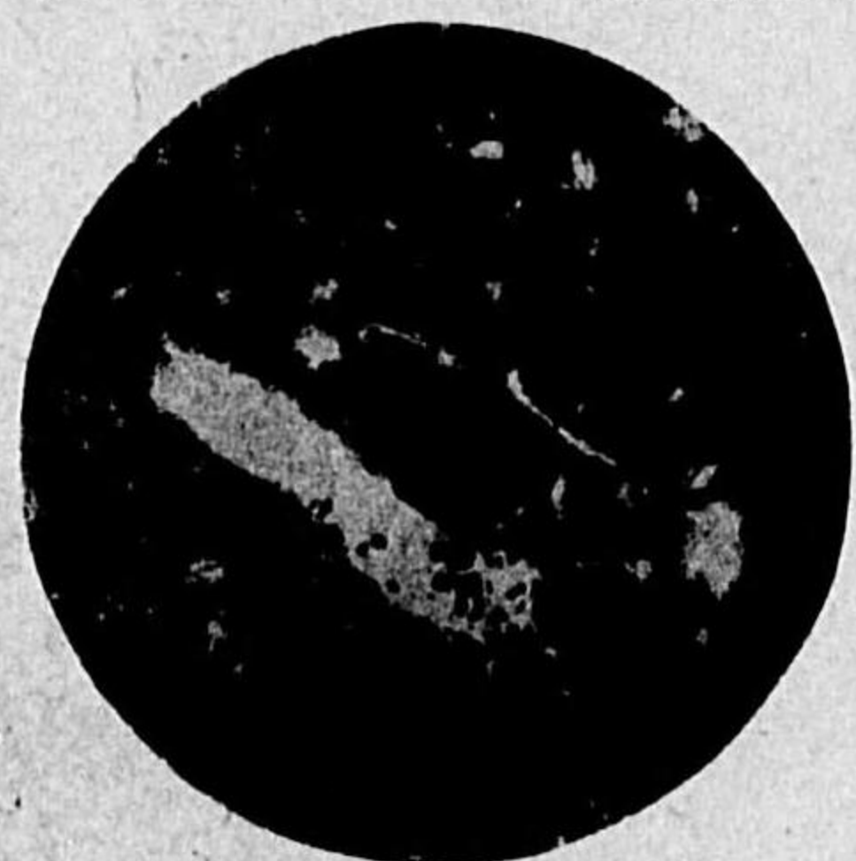
九州三池炭 均等に炭化して植物組織見えず。植物を破壊したるフラグミヂウム菌の胞子多し
