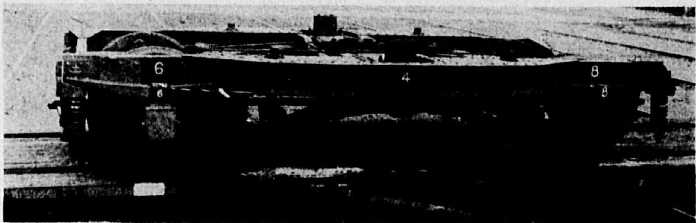
高速列車用臺車の一例ゲルリツツ臺車
