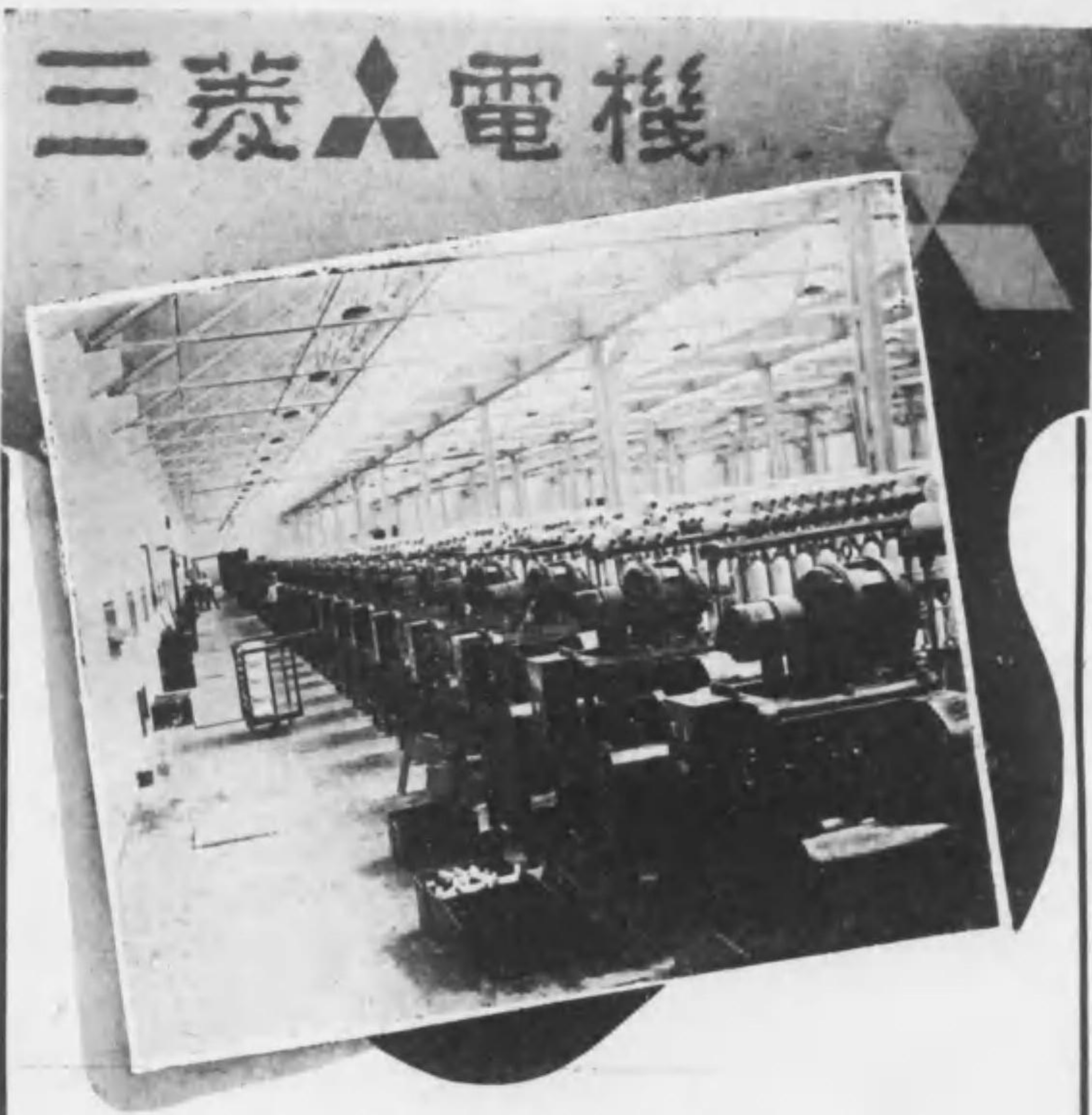
弊社紡績用高率モートルによつて單獨運轉されつゝある精紡機
