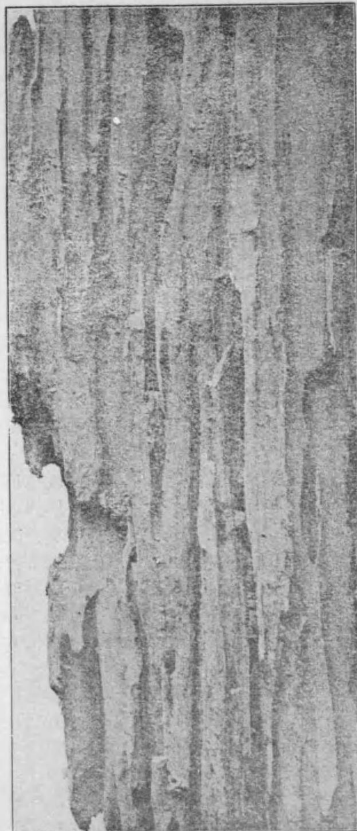
第百四十二圖 白蟻の爲めに蝕害を受けた木材 (Photo by Harold Bestin)
