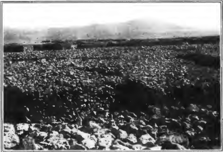
FIG. 7.—Caliche ready for transport to oficina.
