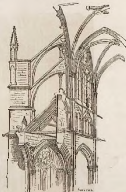
Аміэнскій соборъ. Система корабельнаго устройства. По Виолле-ле-Дюку.
