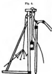
Weite benutzt, welches gleich dem ersten — wie Fig. 3 versuchsweise — unten auf 15 mm verjüngt und zugleich seitlich mit 10 resp. 18 mm großen Löchern versehen war. Auf das obere Ende des Gasrohrs wurde ein Bogenstück geschraubt und dieses mit einem 12 m langen Gummi-Schlauch in entsprechender Weise mit der Pumpe verbunden.
