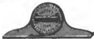
weigte Richtungen fest legen. Die Libelle ist in dem Durchmesser eines gebreiteten Krises befestigt, der seinerseits um einen Zentralpunkt drehbar ist; dieser liegt in dem vertikalen Schenkel eines Winkels, dessen horizontaler Schenkel, mit welchem die Libellenaxe in normaler Lage parallel ist, eine kleine Feder mit Index trägt. Durch eine Saas an dieser Feder kann der Theilkreis — und mit demselben die Libella — in jeder beliebigen geeigneten Lage fest gehalten werden.
